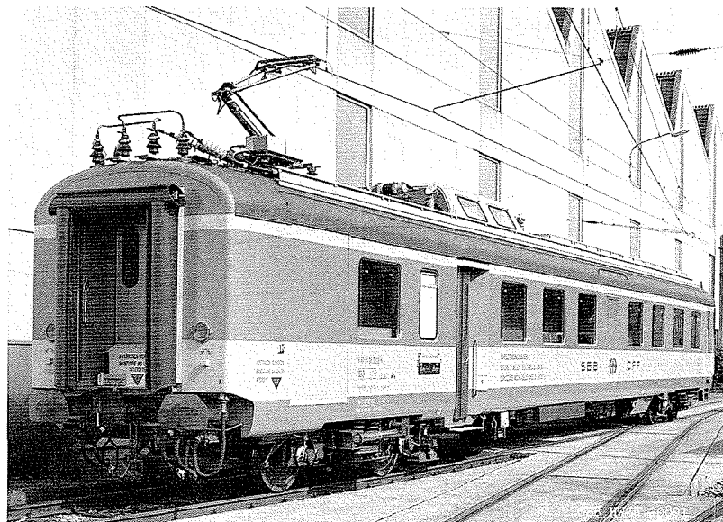
F 1.7./3 Fahrleitungs- meßwagen der SBB von 1981 [HWZ Zürich]
