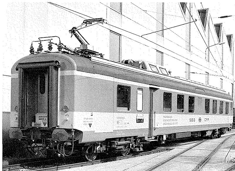
F 1.7./3 Fahrleitungs- meßwagen der SBB von 1981 [HWZ Zürich]
