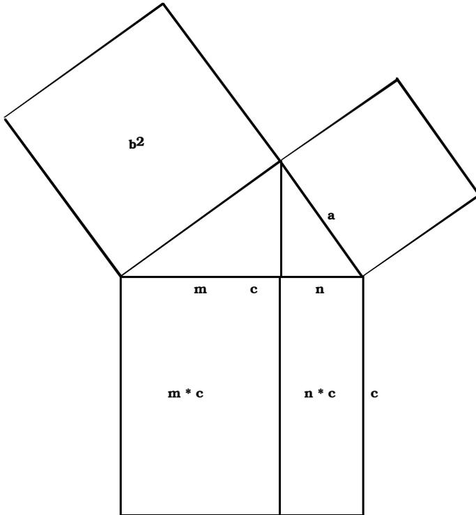
Der **Hypotenusenabschnitt** (A - H<sub>c</sub>) wird mit dem Buchstaben **m** bezeichnet.
